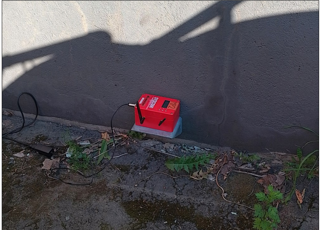
Kuva 5.3. Mittarin asennus sokkeliin kulmaraudalla.
